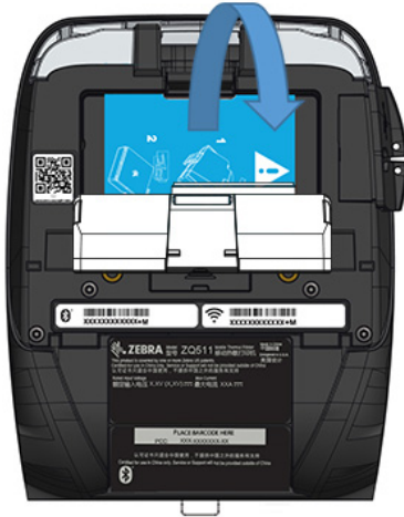
図 6 バッテリーの取り外し
