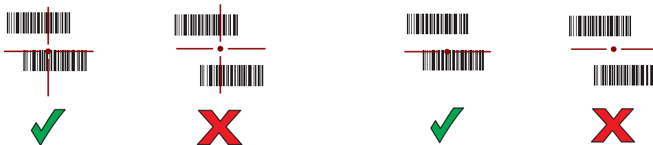
図 39 ピック リスト モード (複数のバーコードが照準パターン内にある場合): 基準範囲および基準範囲外
