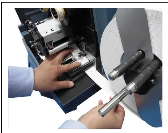
3. 用紙をガイドローラー、用紙エンドセンサー下を通して、用紙を本体奥側に押し付けながら先端をプラテンに合わせます。
