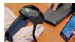
従来のラベルに印刷されたバーコードや、携帯電話、タブレット、コンピュータ画面に表示されたバーコードをキャプチャ
