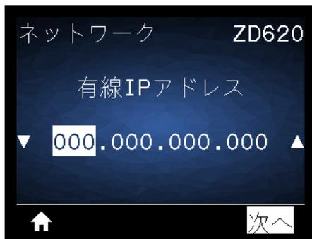
**説明:** プリンタの有線 IP アドレスを表示し、必要に応じて変更します。
