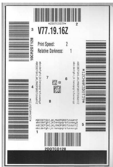
4. 図 3 および表 2 を参照してください。テスト・ラベルを検査して、どのラベルがアプリケーションに最適な印刷品質であるか判断します。バーコード検証器がある場合は、バーコード検証器を使用してバー/空白部分を測定し、印刷のコントラストを計算します。バーコード検証器がない場合は、目視およびシステム・スキャナを使用して、このセルフ・テストで印刷されるラベルに基づいて最適な濃度設定を選択することをお勧めします。
