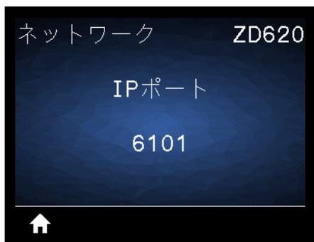
**説明:** このプリンタ設定は、TCP プリント・サービスがリスンしているワイヤレス・プリント・サーバのポート番号を参照します。ホストからの通常の TCP 通信は、このポートに送信される必要があります。
