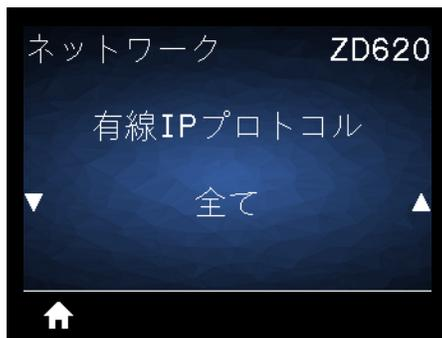
**説明:** このパラメータは、ネット管理者/ユーザー (確定) またはサーバ (ダイナミック) のどちらかで有線プリント・サーバの IP アドレスを選択できるかを示します。ダイナミック・オプションを選択した場合、このパラメータは、プリント・サーバがサーバから IP アドレスを受信する方法を指定します。
