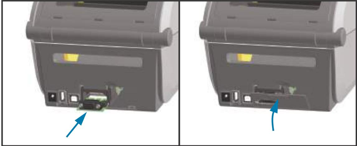
1. DC 電源プラグおよびモジュールのアクセス・ドアを取り外した状態で、シリアル・ポート・モジュールをスライドさせてプリンタに挿入します。回路カードがアクセス・ドアの内側のへりを越えるまでカードをゆっくりと確実に押し込みます。
