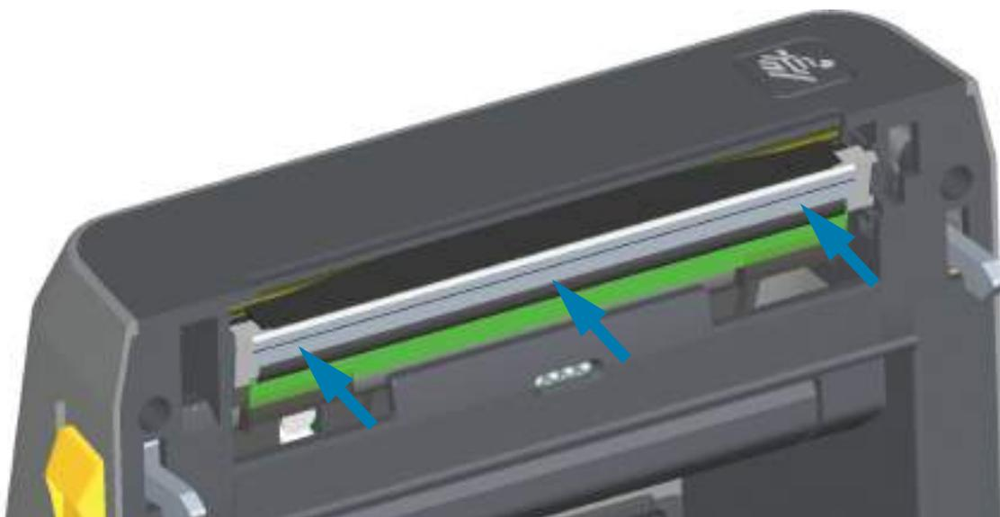
7. 印字ヘッドをクリーニングします。新しいペンをを使用して、印字ヘッドから皮脂（指紋など）や破片を拭き取ります。印字ヘッドの中央から外に向かってクリーニングします。[印字ヘッドのクリーニング](#)を参照してください。
