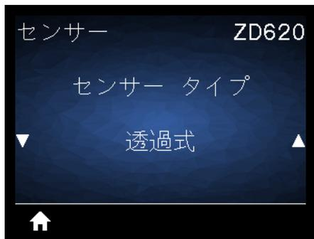
**説明:** 使用する用紙に適切な用紙センサーを選択します。通常、反射式センサーは黒マーク用紙の専用です。透過式センサーは、その他の用紙タイプに使用できます。
