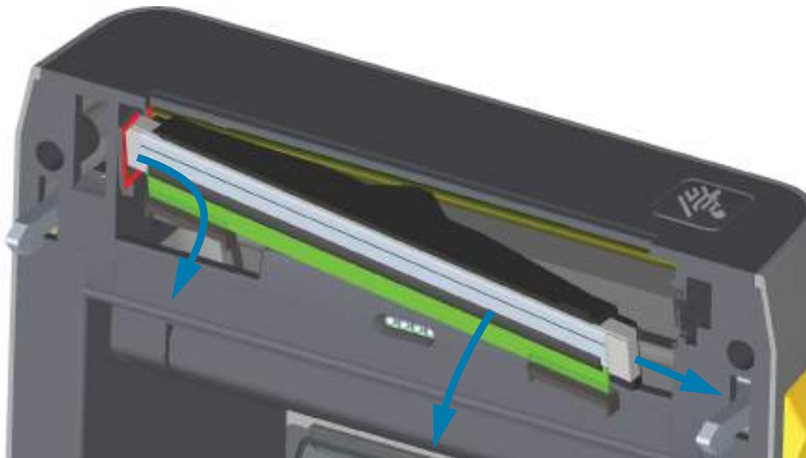
4. 印字ヘッドから、2束の印字ヘッド・ケーブルの接続を丁寧に、しかし確実に引き抜きます。印字ヘッドからアース線を引き抜きます。
