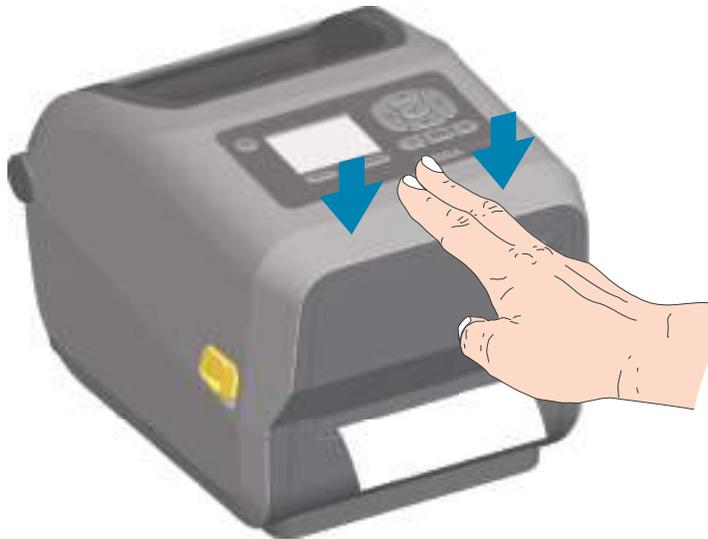
プリンタを用紙にキャリブレーションする必要がある場合もあります。プリンタのセンサーは、ラベル、ライナーおよびラベル間の距離を検知して正常に動作するように調整する必要があります。同じ用紙 ( サイズ、ベンダーおよびバッチ ) を再装着したときは、FEED ( フィード ) ( 前送り ) ボタンを 1 回押して用紙の印刷準備を行えます。
