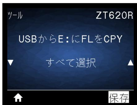
プリンタが実行可能ファイルを読み取って処理します。使用可能なファイルが一覧されます。「すべて選択」を使用すると、USB フラッシュ・ドライブからすべてのファイルをコピーできます。
