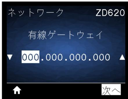
**説明:** デフォルト有線ゲートウェイを表示し、必要に応じて変更します。
