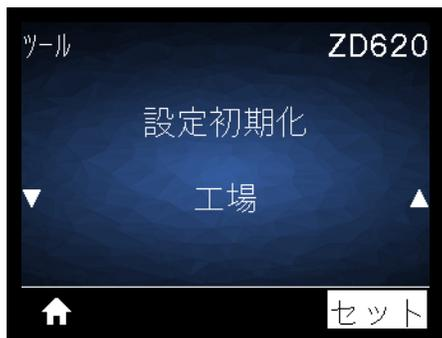
**説明:** 特定のプリンタ、プリント・サーバ、およびネットワークの設定を工場出荷時のデフォルト値に戻します。デフォルト設定を読み込む場合は、手動で変更したすべての設定を再読み込みする必要がありますので、注意してください。このメニュー項目は、それぞれ異なるデフォルト値を持つ2つのユーザー・メニューから利用可能です。
