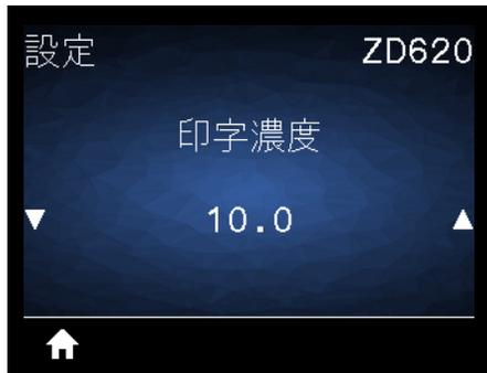
**説明:** 印字濃度は、良好な印字品質が得られる最低値に設定してください。印字濃度の設定が高すぎると、ラベルの印字イメージが不鮮明になったり、バーコードが正しく読み取れなくなったり、リボンが焼け付いてしまったり、印字ヘッドの磨耗を早めてしまう場合があります。
