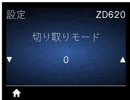
**説明:** ラベルを印刷してから、用紙の静止位置を調整します。静止位置または停止位置は、切り取りポイントをラベルの上または中間に設定します。
