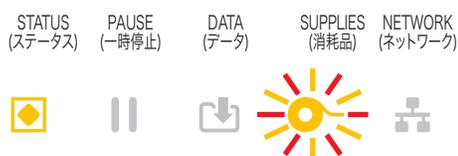
デフォルト値はリボン残量 10% です。用紙インジケータは赤色と黄色に点滅し、ステータス・インジケータは黄色に点灯します。
