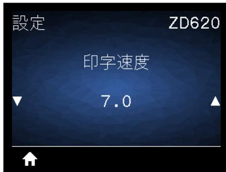
**説明:** ラベル印刷の速度を、1秒あたりのインチ数 (ips) で選択します。通常、印字速度を遅くすると、印字品質は向上します。
