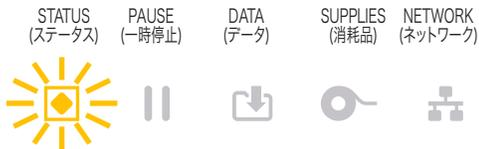
印字ヘッドの温度が低すぎます。通常、動作環境はプリンタの最低動作温度以下です。
