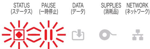
印字ヘッドの温度が高すぎます。**プリンタの電源をオフにします**。プリンタが完全に冷めるまで数分おいてから、プリンタの電源をオンにします。
