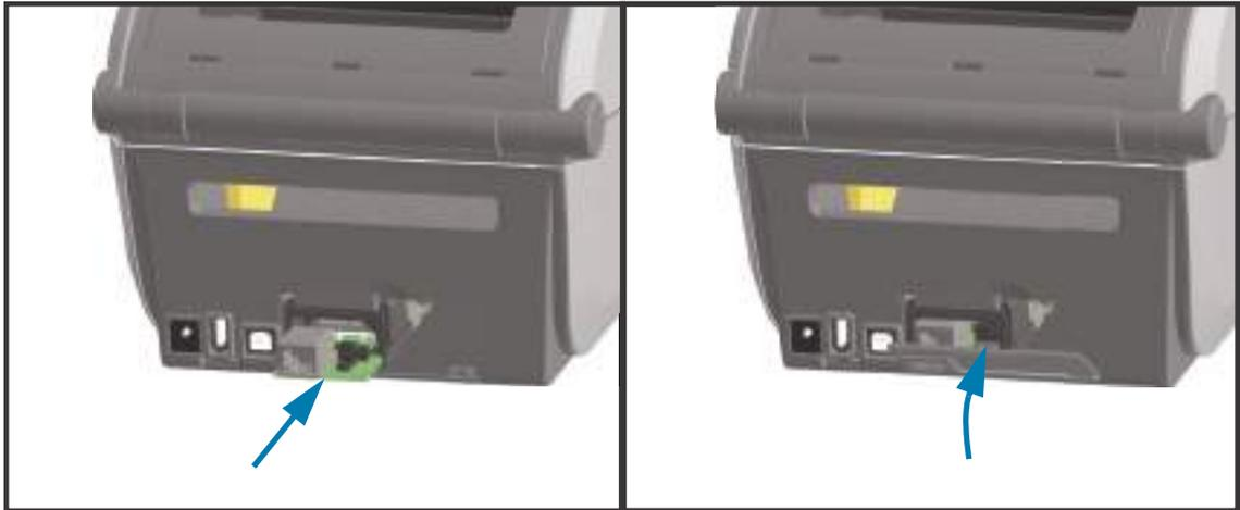
1. DC 電源プラグおよびモジュールのアクセス・ドアを取り外した状態で、イーサネット・モジュールをスライドさせてプリンタに挿入します。回路カードがアクセス・ドアの内側のへりを越えるまでカードをゆっくりと確実に押し込みます。
