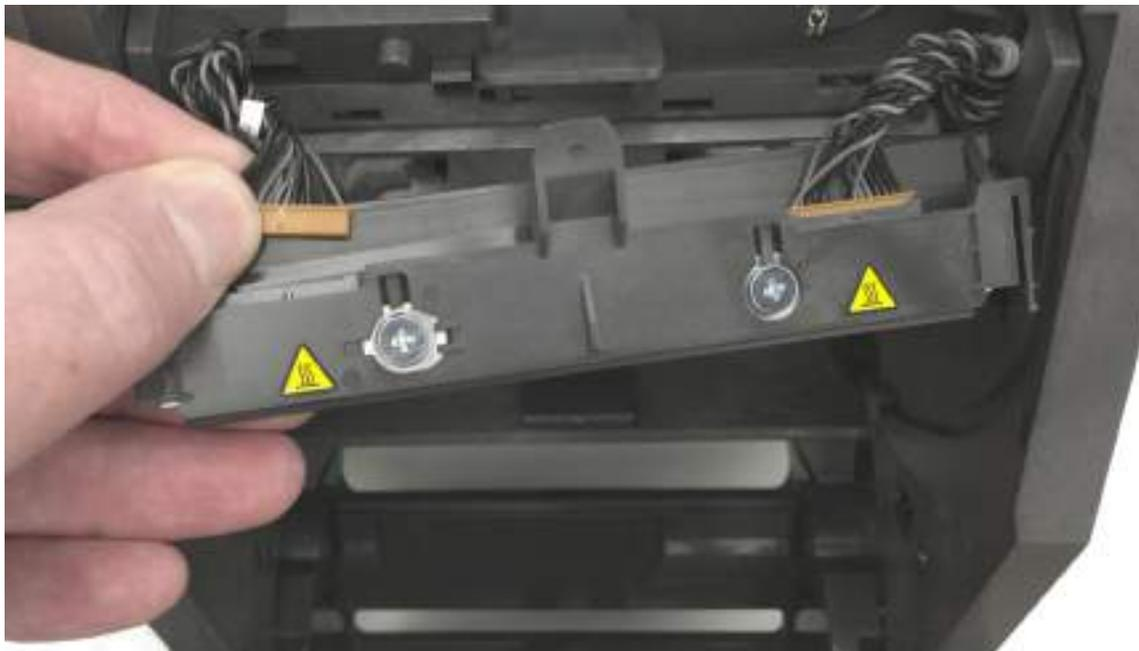
3. 印字ヘッド・アセンブリの中央タブを、印字ヘッド・アクチュエータ・アームの中央スロットに差し込みます。
