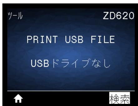
プリンタが実行可能ファイルを読み取って処理します。使用可能なファイルが一覧されます。「**SELECT ALL (すべて選択)**」を使用すると、USB フラッシュ・ドライブ上のすべてのファイルを印刷できます。
