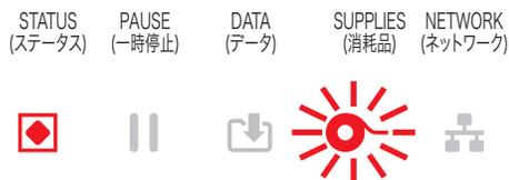
リボン・ロールの端が検出された（反射式リボン・ロールの終端）か、プリンタが熱転写モードのとき、リボンカートリッジがないか、印刷を続行するにはリボン・カートリッジを交換する必要があります。
