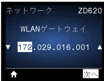
**説明:** デフォルト・ワイヤレス・ゲートウェイを表示し、必要に応じて変更します。
