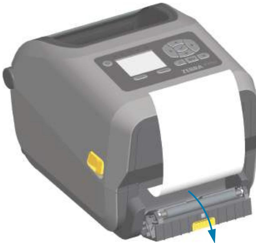
3. ディスペンサ・ドアとプリンタ本体の間にラベル・ライナーを挿入します。
