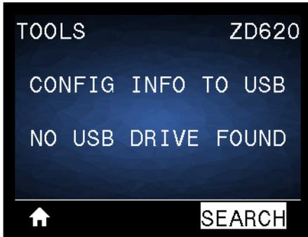
**説明:** オペレータによるプリンタ設定レポートの送信(つまり、ZPL **^HH** コマンドの発行時にプリンタからホスト・システムにデータを返すこと)を可能にします。プリンタにより、ファイル(OUTxxx.txt、ここで xxx = 000 ~ 999)はプリンタの USB ホスト・ポート内の USB ドライブに送られ、情報ごとにフォーマットされます(USB ホスト・ポートおよび Link-OS の使用例 参照)。プリンタ設定レポート・ファイルの名前は、USB ドライブにレポートが書き込まれるたびに増分します(例えば、OUT001.txt は、ファイルの次回書き込み時に増分して OUT002.txt となります)。
