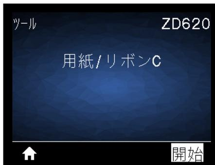
**説明:** 用紙センサーの感度を調整するには、プリンタをキャリブレーションします。
