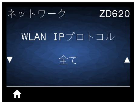
**説明:** このパラメータは、ネット管理者/ユーザー (確定) またはサーバ (ダイナミック) のどちらでワイヤレス・プリント・サーバの IP アドレスを選択できるかを示します。ダイナミック・オプションを選択した場合、このパラメータは、プリント・サーバがサーバから IP アドレスを受信する方法を指定します。
