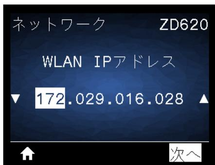
**説明:** プリンタのワイヤレス IP アドレスを表示し、必要に応じて変更します。
