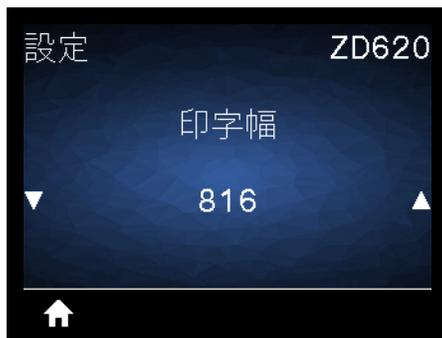
**説明:** 使用するラベルの幅をドットで指定します。デフォルト値は、印字ヘッドの DPI 値に基づいたプリンタの最大幅です。
