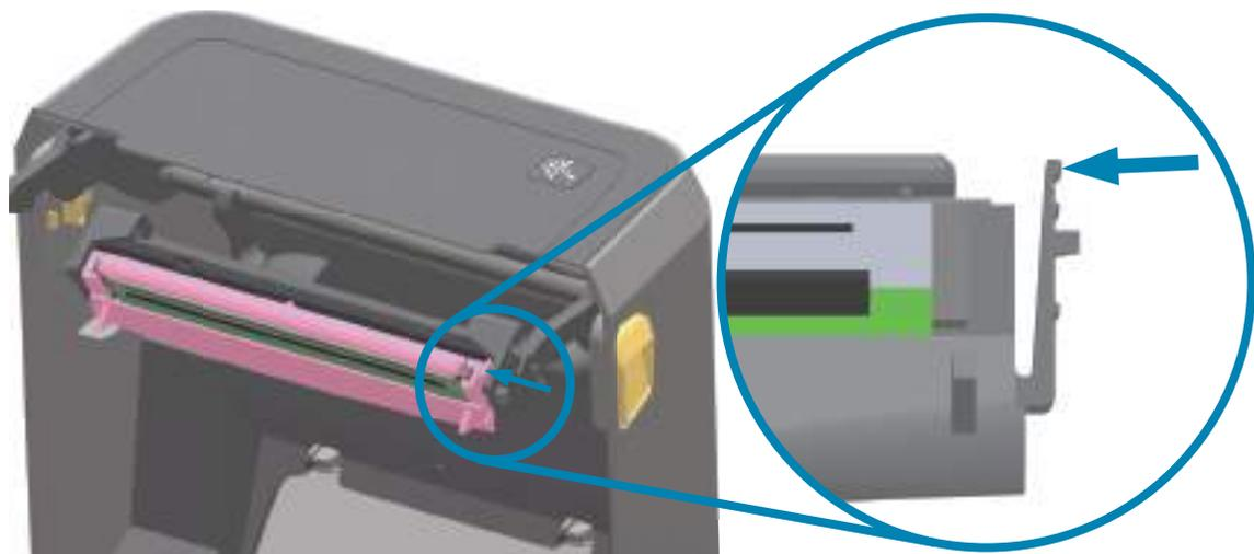
4. 印字ヘッドの自由になった右側をスイングさせてプリンタから外します。右側に少し引くようにして、印字ヘッドの左側を外します。印字ヘッドを下方向に引いて印字ヘッド・アクチュエータ・アームから外し、接続ケーブルにアクセスできるようにします。
