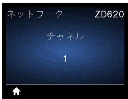
**説明:** ワイヤレス・ネットワークがアクティブになり、認証されると、使用中のワイヤレス・チャンネルを表示します。
