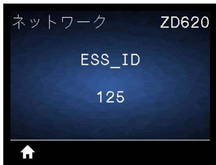
**説明:** Extended Service Set Identification (ESS\_ID) は、ご使用のワイヤレス・ネットワークの ID です。この設定は、現在のワイヤレス設定の ESS\_ID を表示しますが、ユーザー・インターフェイスからは変更できません。
