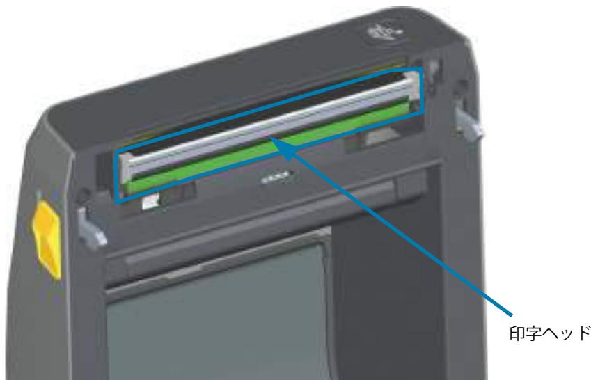
2. 印字ヘッド・リリース・ラッチを押して、印字ヘッドから離します。印字ヘッドの右側が自由になります。
