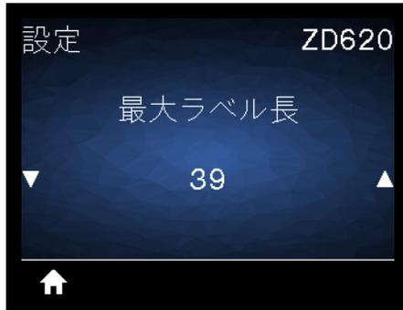
**説明:** この設定で、SmartCal など、プリンタ・ユーティリティが自動的にラベル (黒いマーク、切れ込み、ギャップ/ウェブ) を検出するための距離を制御します。プリンタがラベルを検出してキャリブレーションしない場合、プリンタは連続用紙が装着されていると想定されます。
