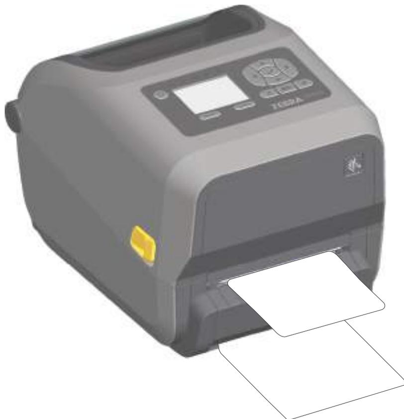
6. 印刷ジョブ中、ラベルは台紙から剥がされて、単独で送り出されます。プリンタからラベルを取り除いて、プリンタに次のラベルを印刷させます。
