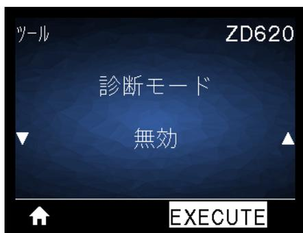
**説明:** プリンタが受信するすべてのデータの 16 進値をプリンタで出力するには、この診断ツールを使用します。詳細については、[通信診断テスト](#)を参照してください。
