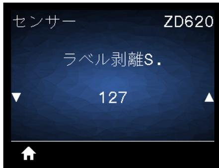
**説明:** センサー回路に取り込まれたラベルの強度を設定します。
