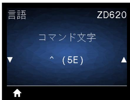
**説明:** このメニューは、フォーマット・コマンドのプレフィックスを変更する場合に使用します。フォーマット・コマンド・プレフィックスとは、ZPL/ZPL II フォーマット命令内でパラメータのプレース・マーカーとして使用する ASCII (括弧内の 2 桁の 16 進値) です。プリンタは、ZPL/ZPL II フォーマット命令の開始を示すこのコマンド文字を検索します。
