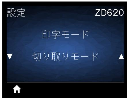
**説明:** ご使用のプリンタ・オプションに対応する印字モードを選択してください。別のプリンタ・オプションを選択した場合の印字モードの動作については、[印字モードの選択](#)を参照してください。
