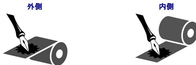
図8・コーティング面が外側のリボンとコーティング面が内側のリボン
