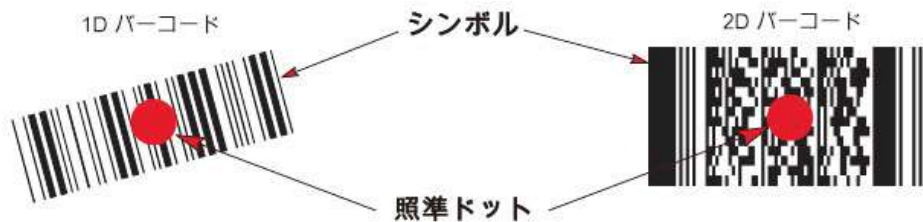
図 12 イメージャ照準ドットでのスキャン方向
