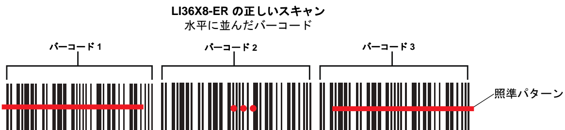
図 5-2 LI36X8-ER のバーコード スキャンのサンプル
