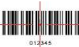
図 2-7 DS36X8-HD および DS36X8-HP 照準パターン
