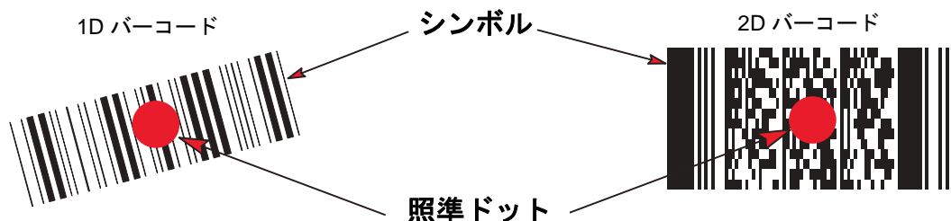
図 2-7 照射ドットによるスキャン位置確認
