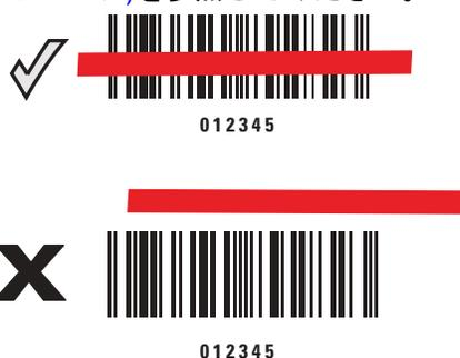
図 2-6 照準ラインによるスキャン位置確認
