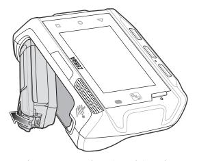
4. バッテリのシルバーの側の端を、バッテリスロットに入れます。
