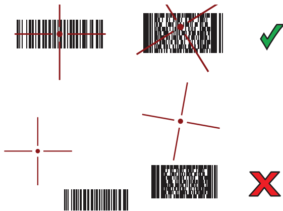
図 87 ピック リスト モード：複数のバーコードが照準パターン内にある場合
