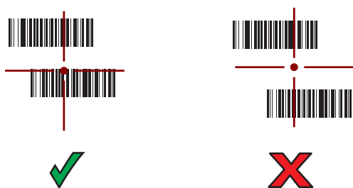
図 87 ピック リスト モード：複数のバーコードが照準パターン内にある場合
