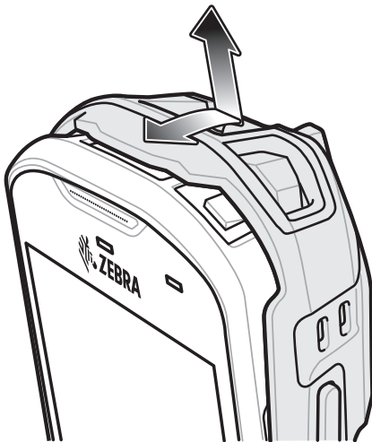
図 146 ブーツをデバイス上部に持ち上げる
