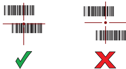
図 84 ピックリストモード：複数のバーコードが照準パターン内にある場合
