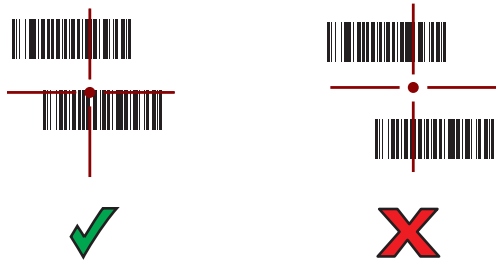
図 90 ピック リスト モード: 複数のバーコードが照準パターン内にある場合
