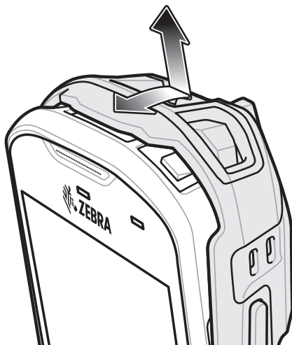
図 118 ブーツをデバイス上部に持ち上げる
