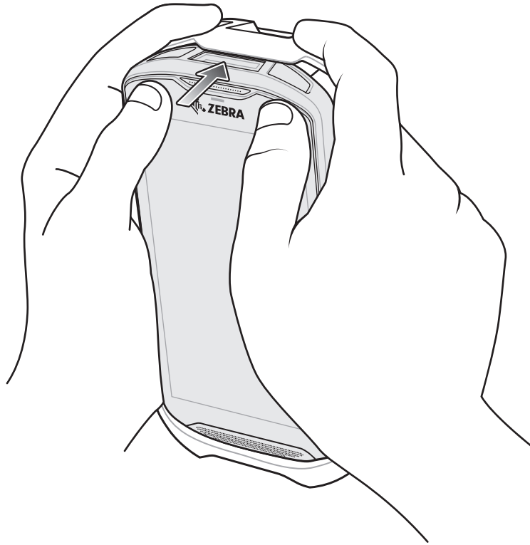
図 147 デバイスをブーツに押し込む
