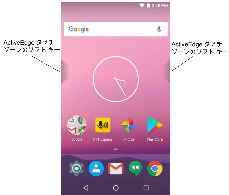
図 39 [Left ActiveEdge Zone] (左 ActiveEdge ゾーン) を [Scanner] (スキャナ) に設定、[Right ActiveEdge Zone] (右 ActiveEdge ゾーン) を [Drawer] (ドロワー) に設定している例
