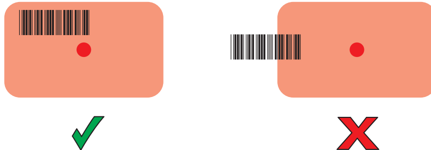
図 72 SE4710 ピック リスト モード: 複数のバーコードが照準パターン内にある場合
