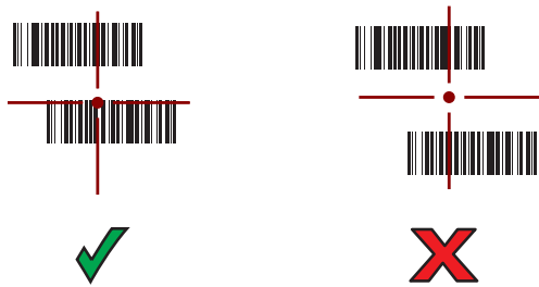
図 78 ピック リスト モード: 複数のバーコードが照準パターン内にある場合
