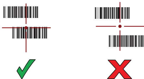
図 75 ピック リスト モード: 複数のバーコードが照準パターン内にある場合
