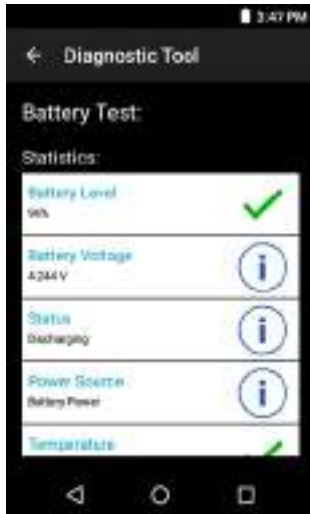
図83 バッテリ サブシステムの詳細情報
