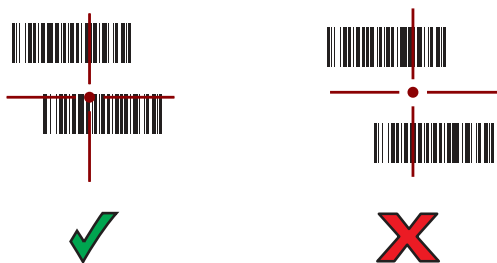
図 77: ピック リスト モード: 複数のバーコードが照準パターン内にある場合
