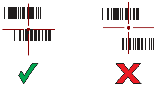
図 80: ピック リスト モード: 複数のバーコードが照準パターン内にある場合
