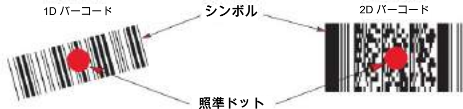
図 16 イメージャ照準ドットでのスキャン方向
