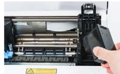
ハーフカット用のナイフが摩耗して切れにくくなっても、ロックを外してナイフを差し替えるだけです。
