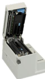
Eta420 シリーズで好評だったヘッドカバーの横向き開放方式を採用しました。カバーと一緒にヘッドが90度開放するので、用紙の交換も「開く」「セットする」「閉める」の3アクションで完了します。用紙の補充や交換がとても簡単になります。
